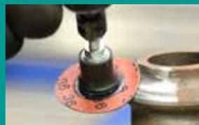
**CONSEJO.** Evite el raspado en contornos utilizando un soporte de menor tamaño que el diámetro de los discos, por ejemplo, un soporte de 38 mm para 50 mm.
