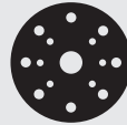
Ø150 mm con 15 agujeros Ø9 mm en círculo de agujero Ø120 mm; 6 agujeros Ø9 mm en círculo de agujero Ø80mm + 1 agujero central Ø17 mm
